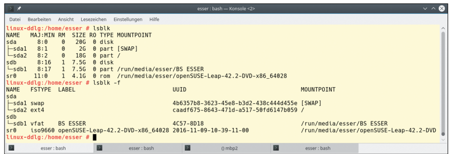
Abb. 3: Das Tool „lsblk“ zeigt ausführliche Informationen zu Blockgeräten. Partitionen erscheinen in einer Baumstruktur unterhalb der zugehörigen Platte.
