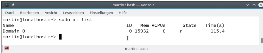
Abb. 7: Wenn Sie unter OpenSuse den Xen-Kernel booten, rufen Sie im Anschluss „sudo xl list“ auf, um zu testen, ob Xen funktioniert.
