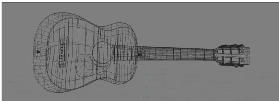
Abb. 1: Räumliche Objekte entstehen in Blender als Gitternetze, die die Ausdehnung in die dritte Dimension andeuten.
